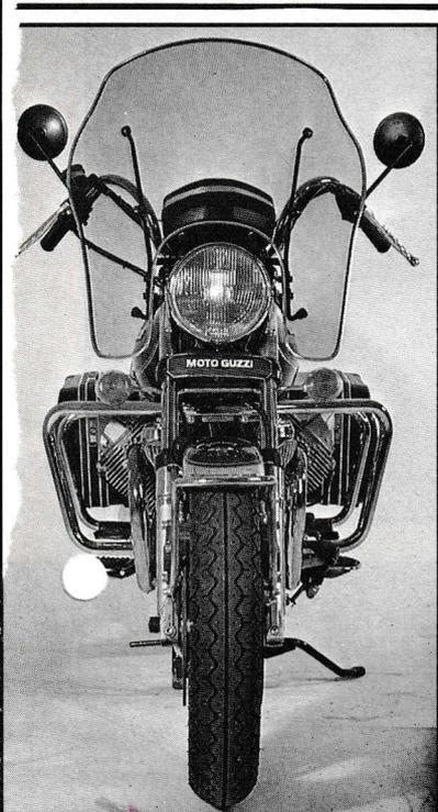
**Hohe Scheibe, wuchtige Kotflügel und breite Schutzbügel machen aus der an sich zierlichen Guzzi ein Schlachtschiff, das 279 Kilo auf die Waage bringt.**
